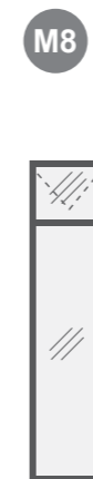
ช่องแสงกระจกใสบานตาย กว้าง 0.70 ม. สูง 2.60 ม.
