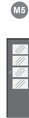
ประตูไม้กรุกระจกใส กว้าง 0.885 ม. สูง 1.96 ม.
